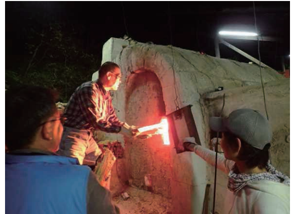
三の間に薪を投入
