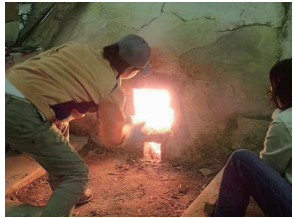
胴木間に薪を投入
