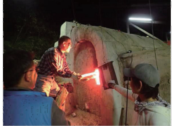
三の間に薪を投入
