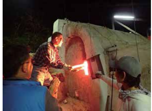
三の間に薪を投入
